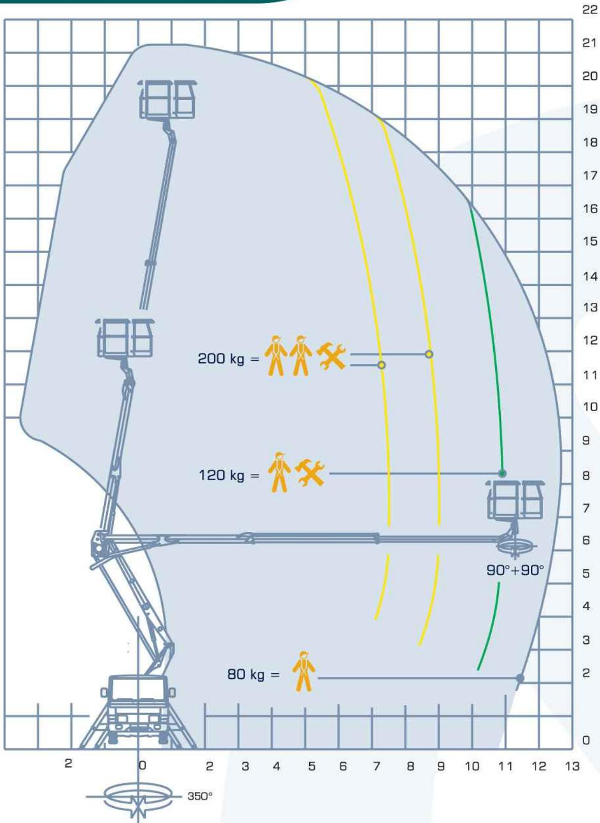
La Snake 2112 SMART è capace di un'altezza massima di lavoro di ben 21 m e di uno sbraccio laterale pari a 12 m.
